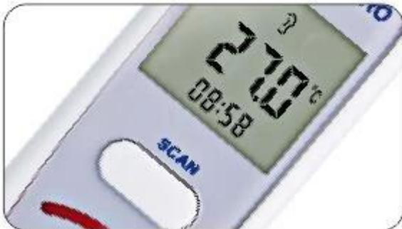
3, la temperatura del oído tienen función automática de la medida. Cuando se coloca en el oído, una medición exacta de la temperatura se ha tomado con la voz "BI", LED verde será el significado de todo está bien. Cuando la lectura es más alta que 38 °C, el LED rojo significará que el bebé es fiebre.
